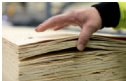
Granen passar utmärkt som baksidesfaner till parkettgolv, då den har en sluten cellstruktur och är mindre mottaglig för fukt.
